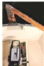
5: helmstok boven de rail geplaatst
