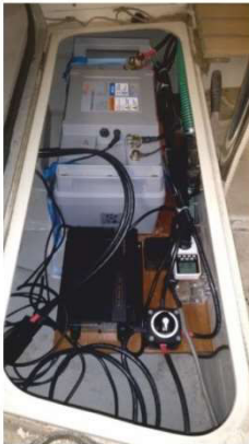
8: ingebouwde accu, lader en de overige componenten
