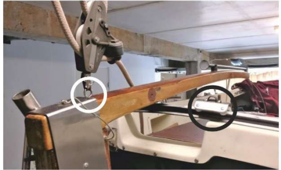
7: nieuwe blokbevestiging van de grootschoot
