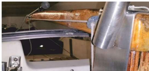
2: helmstok boven de overlooprail geplaatst
